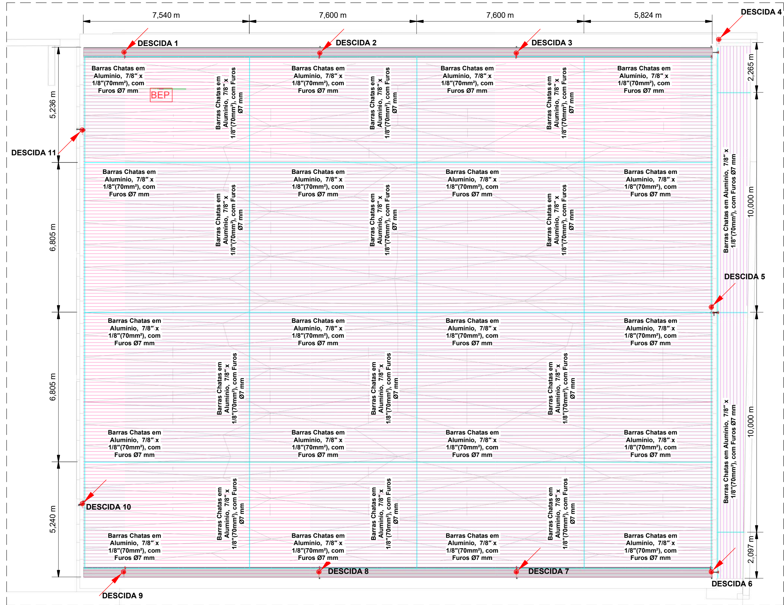
01 PLANTA DE COBERTURA - SISTEMA DE CAPTAÇÃO ESCALA 1:100
